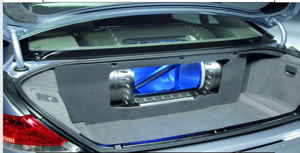
На BMWHydrogen 7 установлен бензобак 74 литра и баллон для хранения 5,2 кг водорода
