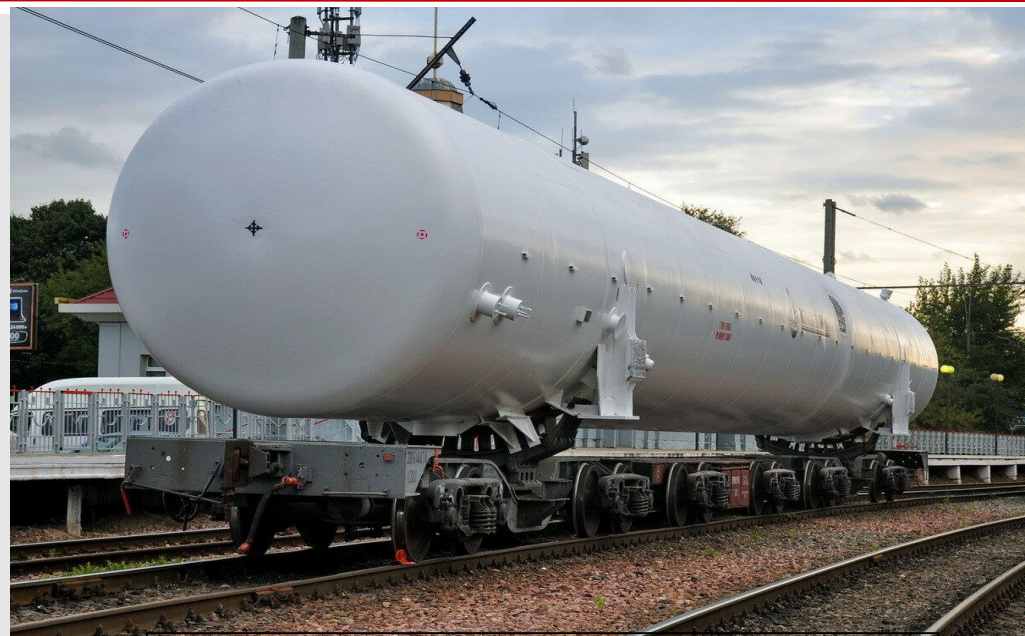
Резервуар для хранения жидкого водорода на 12-ти осных сцепных транспортёрах
