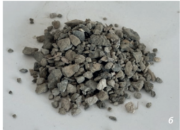
Рис. 6. Фракции просыпи с размером частиц менее 5 мм (а) и вторичного щебня (б) после дробления и разделения отходов строительства и сноса
