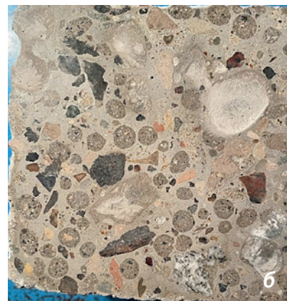
Рис. 8. Образец тяжелого бетона с содержанием 65 % масс. каменных отходов сноса: а — образец-куб; б — сечение образца
