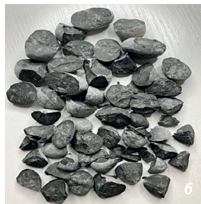
Рис. 7. Гранулят фракции 10–20 мм на основе просыпи и наноцемента (а) и дробленый гранулят для использования в качестве крупного заполнителя в бетонах (б)
