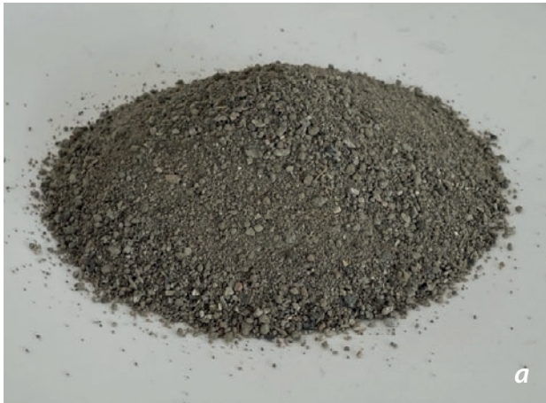
Рис. 6. Фракции просыпи с размером частиц менее 5 мм (а) и вторичного щебня (б) после дробления и разделения отходов строительства и сноса
