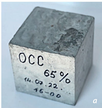
Рис. 8. Образец тяжелого бетона с содержанием 65 % масс. каменных отходов сноса: а — образец-куб; б — сечение образца
