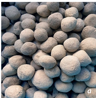
Рис. 7. Гранулят фракции 10–20 мм на основе просыпи и наноцемента (а) и дробленый гранулят для использования в качестве крупного заполнителя в бетонах (б)
