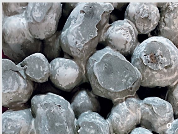
Материал «КАПСИМЭТ»: а — образец плотностью 620 кг/м 3 ; б — в качестве объемного заполнителя наружной стены строящегося дома с каркасом из трубобетона (пос. Немчиновка Московской области, 2007 год)
